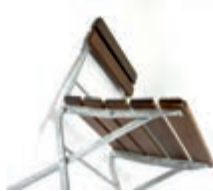
Detail Sitz unten: Winkleisen unter dem Sitz, Drehpunkte sind genietet
