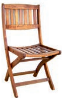
Belvedere NL o. Arm Klappbar, Beschläge verzinkt, Sitz und Rücken gerahmt Verdeckt gedübelt und verleimt, Robinie geölt oder lasiert
